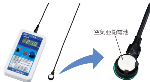
図6 空気亜鉛電池を用いた酸素センサー 提供：ケニス株式会社
