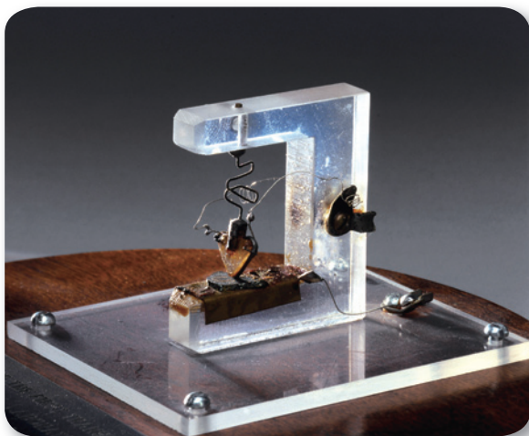
世界初のトランジスタ（複製） 本体はコの字型のプラスチック製支柱に囲まれた部分。高さ約10cm。所蔵：Science Museum, London
